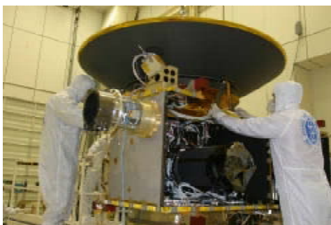
Příprava posledního radioizotopového generátoru typu GPHS-RTG připravovaného pro sondu New Horizons a tato sonda. (Zdroj NASA)
