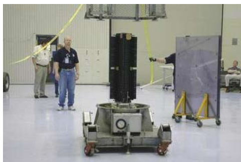
Příprava posledního radioizotopového generátoru typu GPHS-RTG připravovaného pro sondu New Horizons a tato sonda. (Zdroj NASA)
